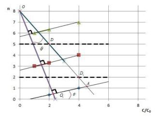
Рис. 7. Зависимости величин n, соответствующих максимальным значениям относительных амплитуд первых гармоник коэффициентов Фурье флуктуаций дифференциальной температуры промежуточной жидкости (дистиллированной воды) от относительной объемной концентрации растворенных вешеств
