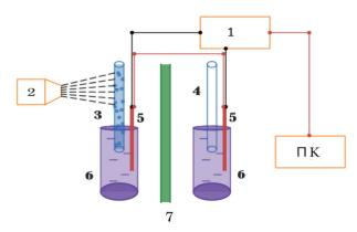
Рис. 1. Блок—схема измерительного комплекса: ПК — персональный компьютер; 1 — измерительный блок дифференциальной и простой термопар; 2 — генератор шума; 3 — пробирка с исследуемым веществом; 4 — пробирка с эталоном; 5 — термопары; 6 — пробирки с дистиллированной водой;
