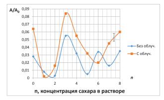
Рис. 4. Зависимости относительных амплитуд первых гармоник разложения  $\Phi$ урье для смеси растворов на основе 9.52% растворов сахара и 13.08% растворов соли
