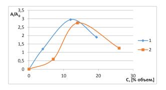
Рис. 2. Зависимость относительных амплитуд первых гармоник разложения Фурье от концентрации растворов: 1 — для сахарозы; 2 — для поваренной соли
